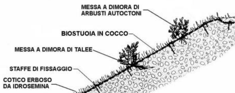
Consolidamento degli argini con biostuoie e tappezzanti arbustive
