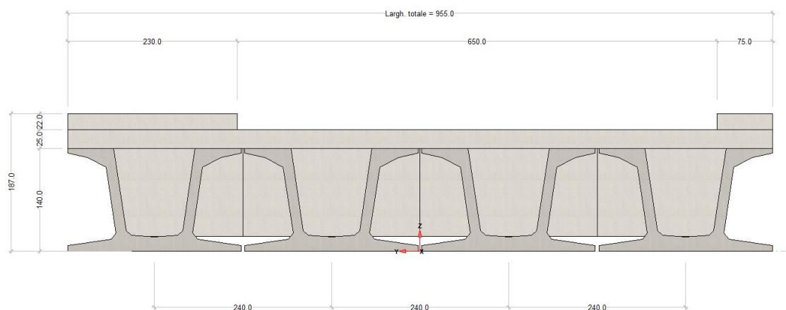
Sezione trasversale impalcato
